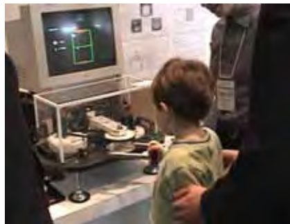
Fig. 25. Passive force display using ER brakes
