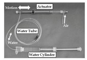
Fig. 8. Hydraulic linear actuator
